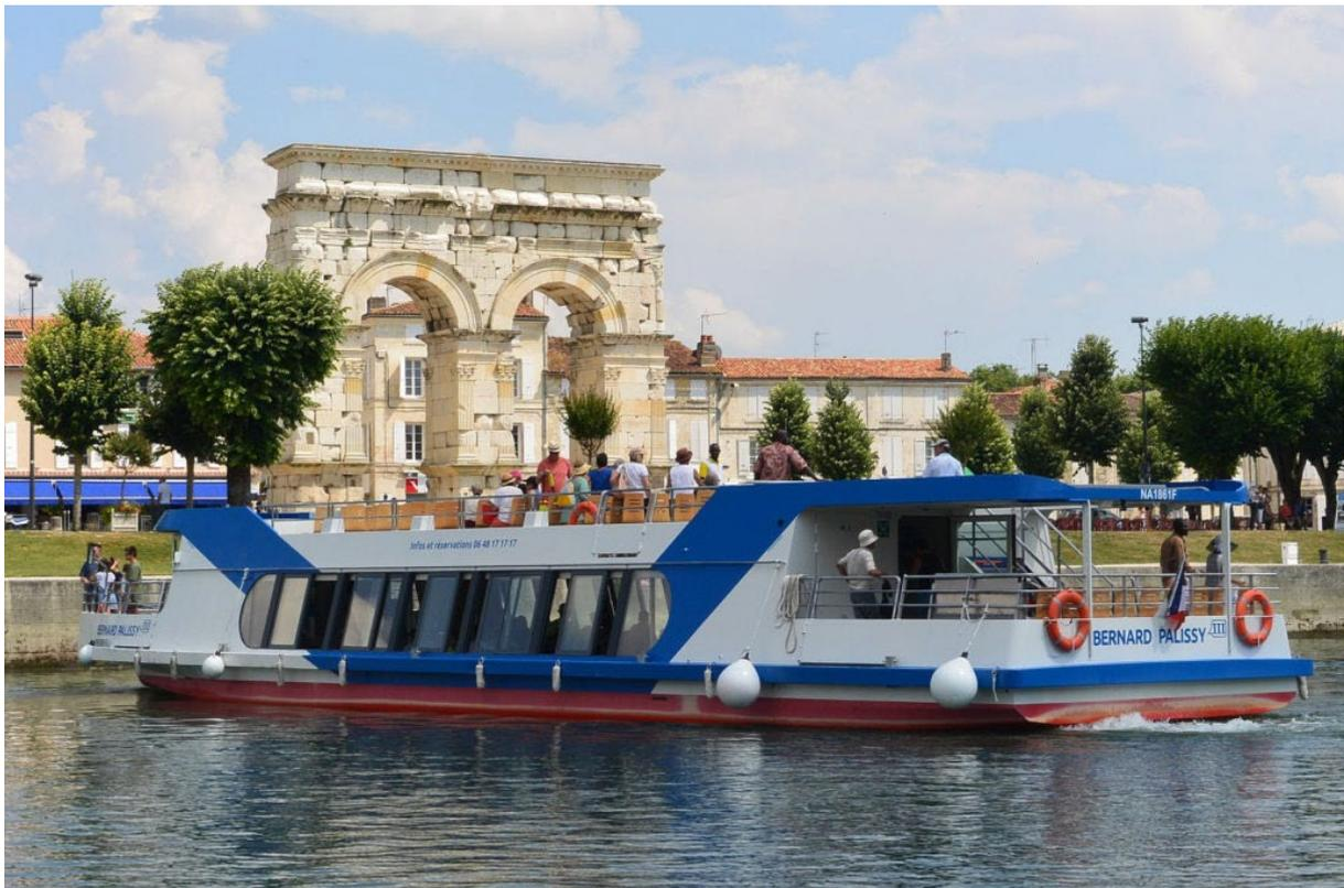
En effet, nous embarquons sur le Bernard Palissy III pour une croisière sur le fleuve. Le bateau est 100% électro-solaire grâce à des panneaux situés sur le toit. Ils permettent de répondre aux besoins électriques de l'embarcation. Le bateau est donc silencieux et sans émission de CO2.
